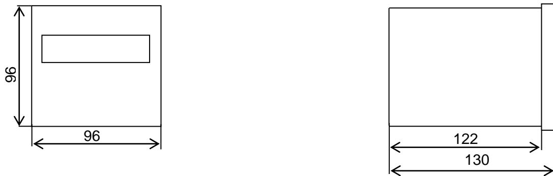
**Рисунок В.3 – Габаритные размеры устройств 96x96x130 mm**
