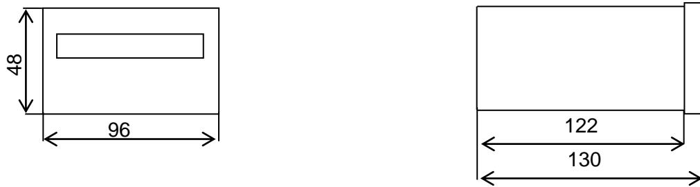
**Рисунок В.7 – Габаритные размеры устройств 96x48x130 mm**
