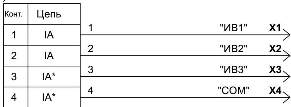
Рисунок Б.6 – Схема жгута № 15 для подключения УПП8531М/5
