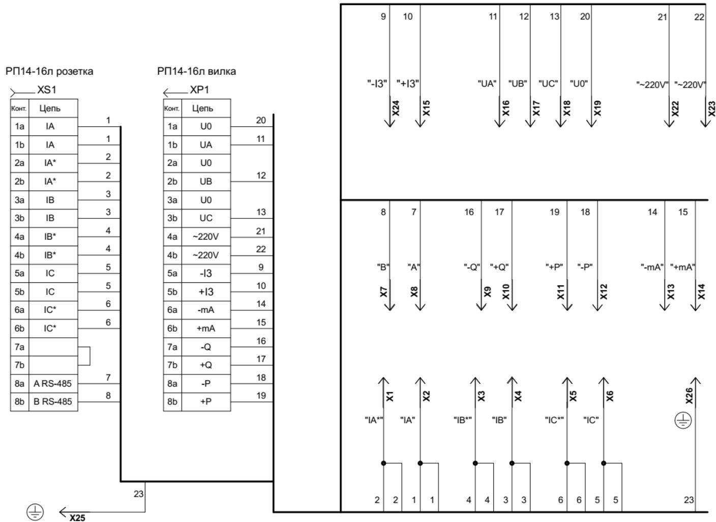
Рисунок Б.5 – Схема жгутов № 1.1 и 2.1 для подключения УПП8531М/5
