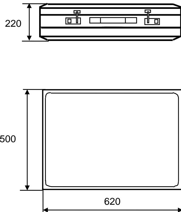
**Рисунок А.1- Габаритные размеры УПП**
