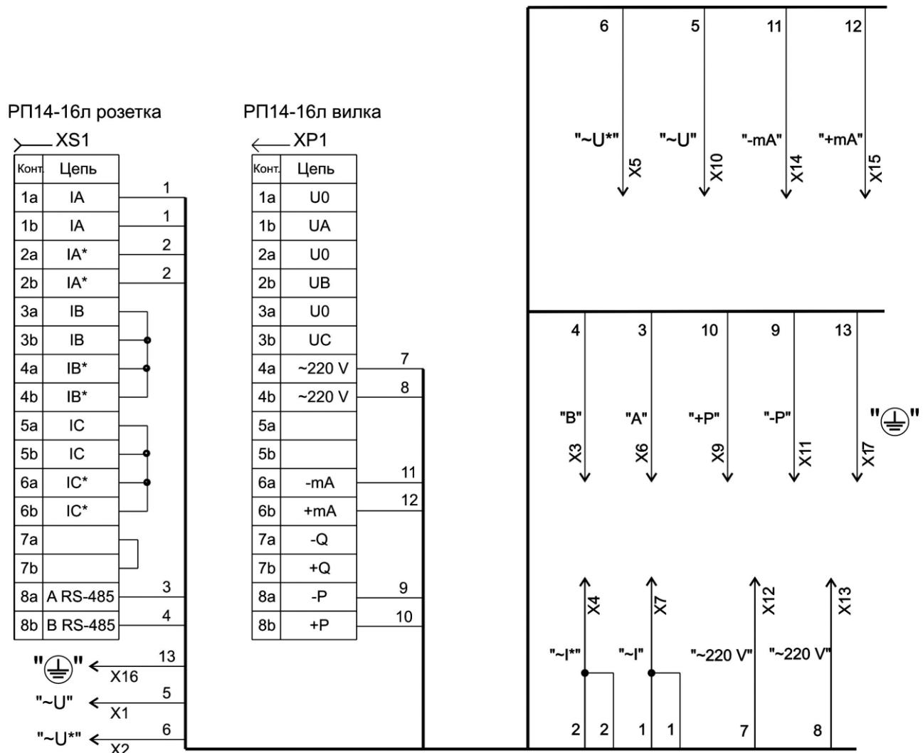
Рисунок Б.3 – Схема жгутов № 4, № 5 для подключения УПП8531М/3
