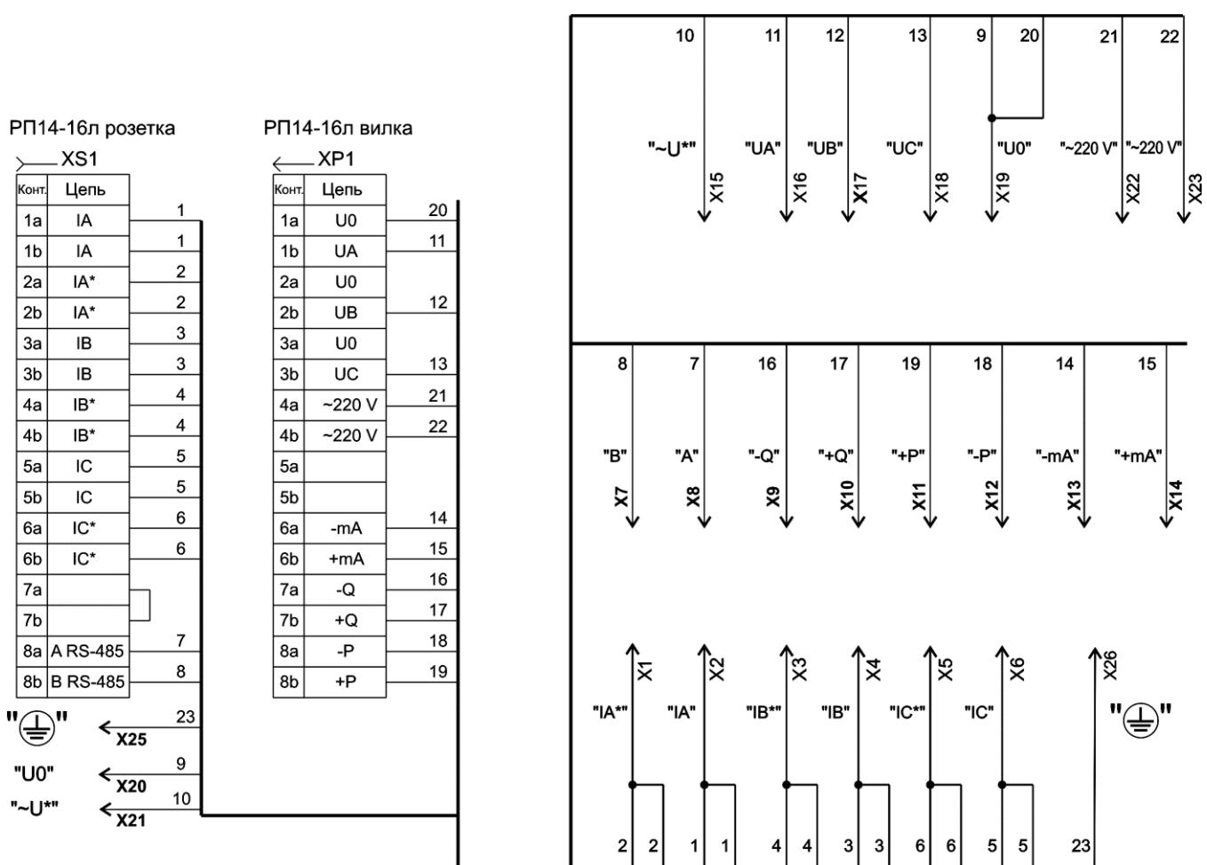
Рисунок Б.1 – Схема жгутов № 1, № 2 для подключения к УПП8531М/1, УПП8531М/2
