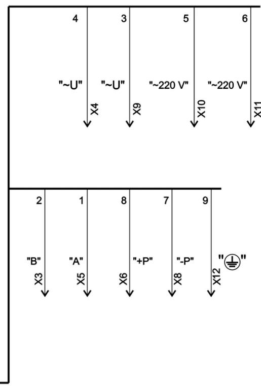
Рисунок Б.4 – Схема жгутов № 6, № 7 для подключения УПП8531М/4
