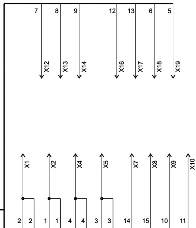
Рисунок Б.2 – Схема жгута № 3 для подключения при поверке ИП ЭП8530М/1-ЭП8530М/24 (аналог Е849), ЭП8530, ЭП8509, ЭП8520
