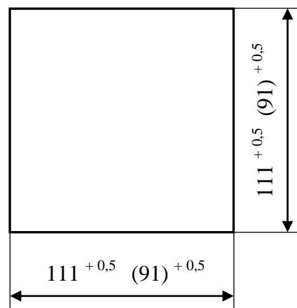
**Рисунок Г.2 – Размеры окна в щите для установки указателя**
