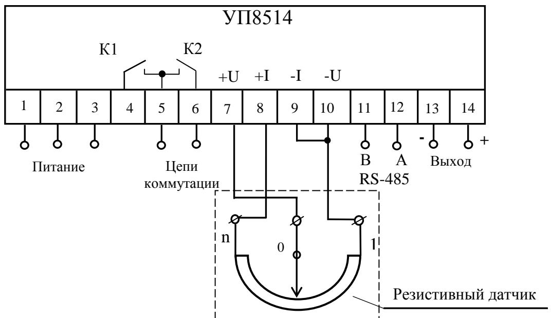
**Рисунок Д.3 – Схема электрическая подключения указателей УП8514/1, УП8514/2 с габаритными размерами 96x96x130 мм при трехпроводном подключении резистивного датчика**
