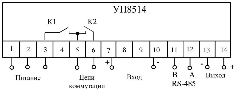
**Рисунок Е.1 – Схема электрическая подключения указателей УП8514/3-УП8514/6 с габаритными размерами 120x120x130 mm**
