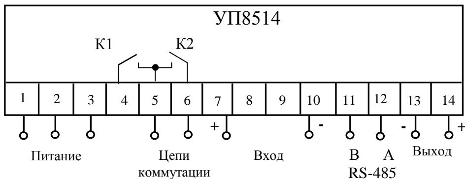
**Рисунок Е.2 – Схема электрическая подключения указателей УП8514/3-УП8514/6 с габаритными размерами 96x96x130 mm**
