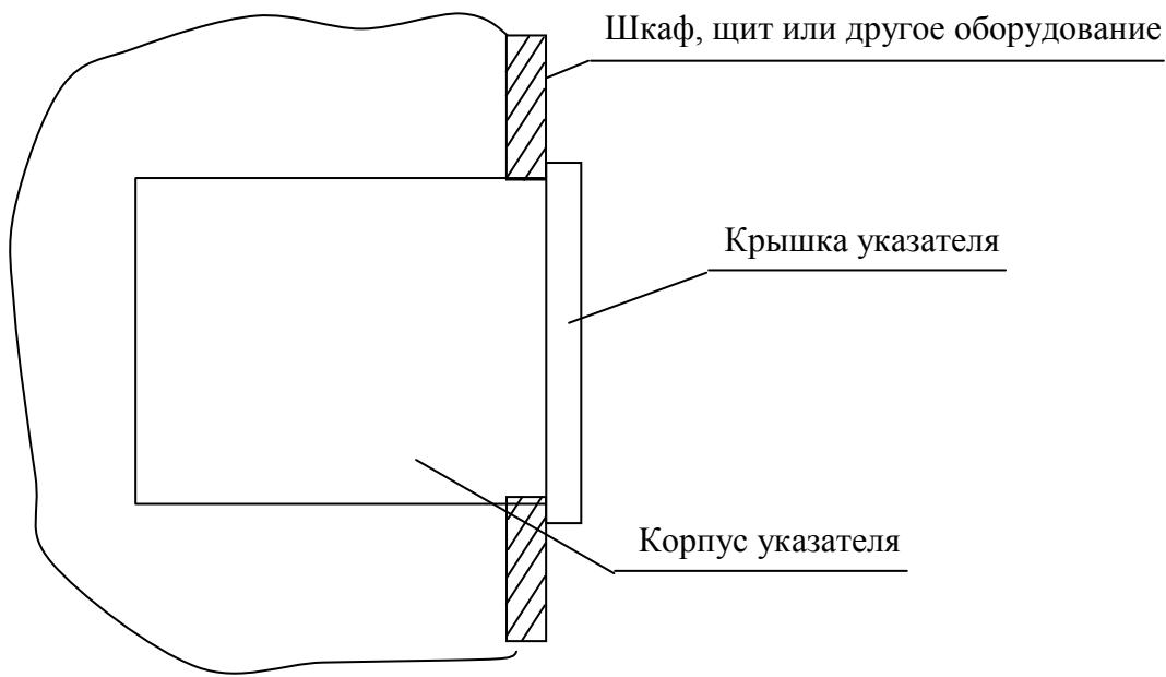
**Рисунок Г.3 – Установка указателя в шкафы, щиты или другое оборудование**
