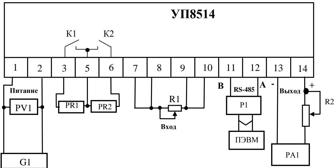
УП8514 – проверяемый указатель положения;
