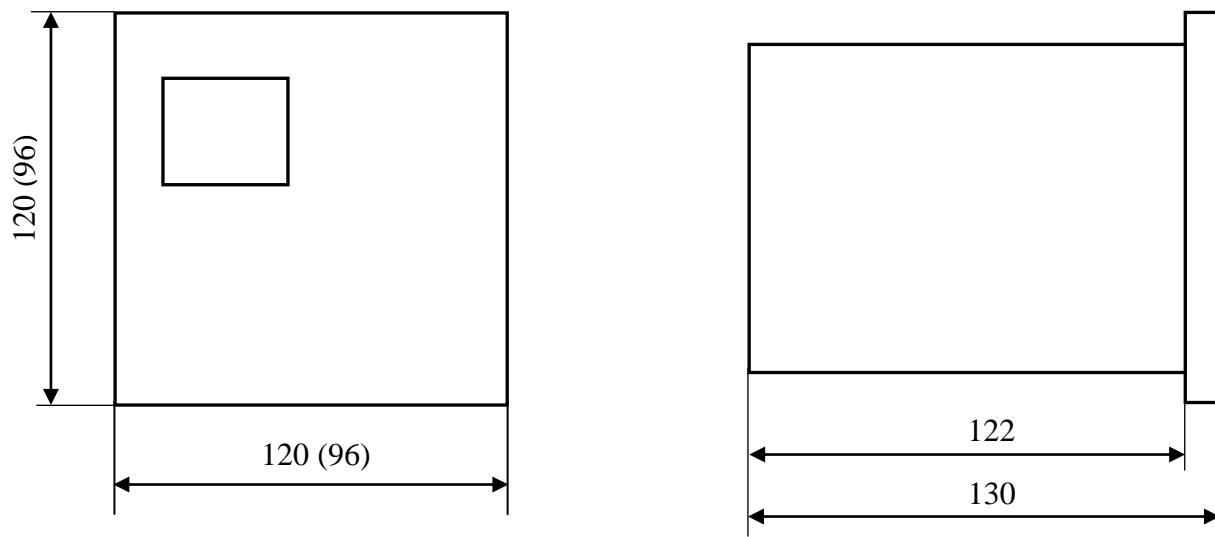
**Рисунок Г.1 – Габаритные размеры указателя**
