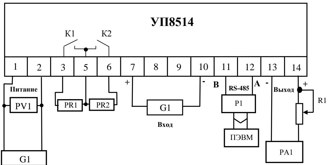
УП8514 – проверяемый указатель положения;
