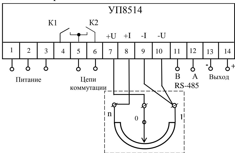
**Рисунок Д.4 – Схема электрическая подключения указателей УП8514/1, УП8514/2 с габаритными размерами 96x96x130 мм при четырехпроводном подключении резистивного датчика**
