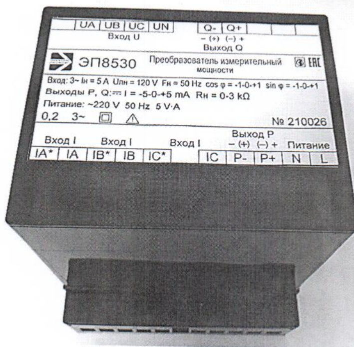
Рисунок 1.4 – ЭП8530 в корпусе с габаритными размерами 125x90x125 мм
