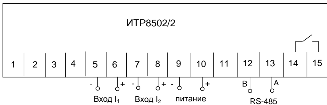
Рисунок Г.1 - Схема электрическая подключения ИТР8502 с питанием от сети переменного тока напряжением 220 (100) V
