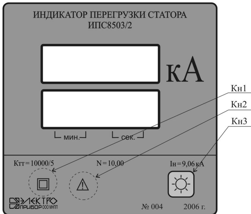
Стрелками указаны места расположения кнопок Кн1, Кн2, Кн3 (функциональное назначение кнопок – см. приложение Д).
