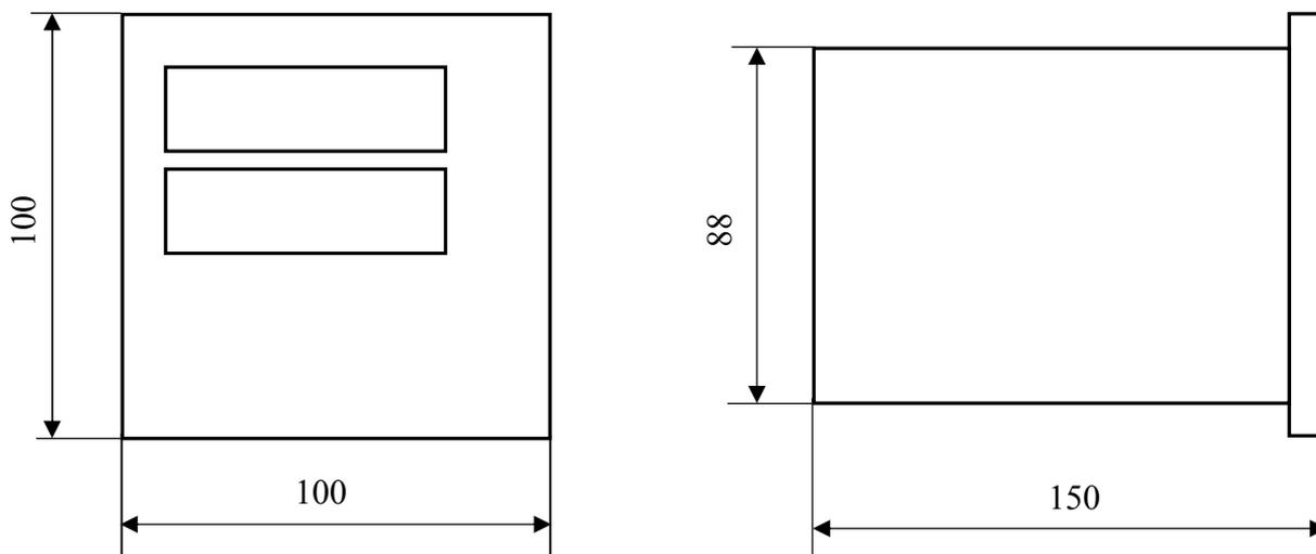
Рисунок А.1 – Габаритные размеры индикатора
