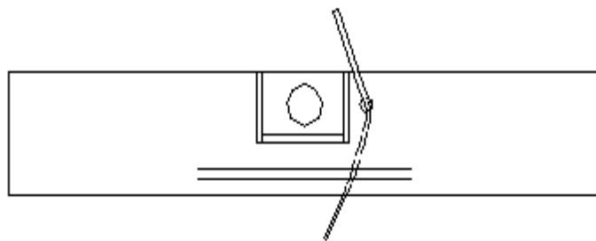
2 Вставить и защелкнуть крышку клеммной колодки
