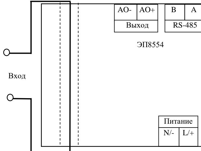
**Рисунок Б.6 – Схемы электрическая подключения одноканальных ЭП8554 с номинальными входными сигналами свыше 5 А в корпусе с габаритными размерами 132x81x71 mm**
