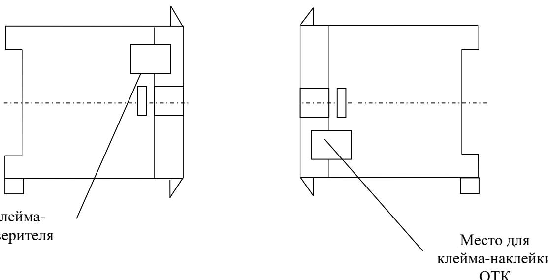
Рисунок В.2 - Схема пломбировки от несанкционированного доступа на ЭП в корпусе с габаритными размерами 55x81x71 mm и 132x81x71 mm (вид сбоку).
