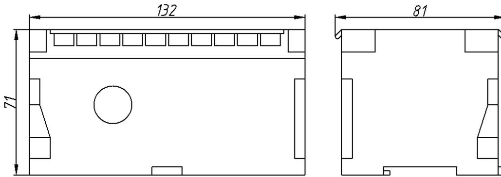
Рисунок А.11 – Габаритные размеры ЭП8554 с входными сигналами свыше 5 А
