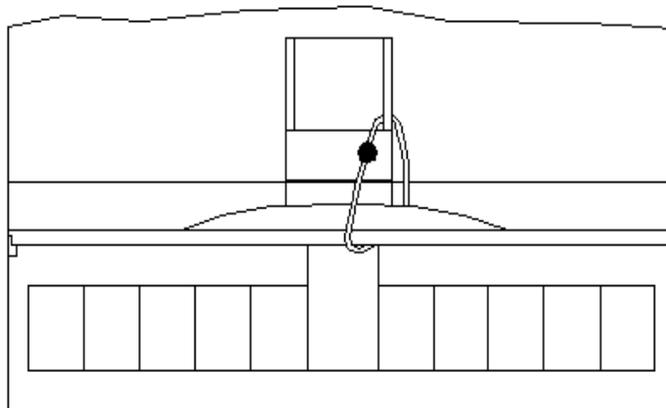
4 Закрепить леску узлом с натяжением, исключая снятие крышки
