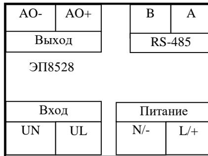
Рисунок Б.9 – Схемы электрическая подключения ЭП8528 в корпусе с габаритными размерами 55x81x71 mm
