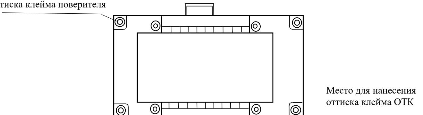
Рисунок В.3 - Схема пломбировки от несанкционированного доступа на ЭП в корпусе с габаритными размерами 125x90x125 mm
