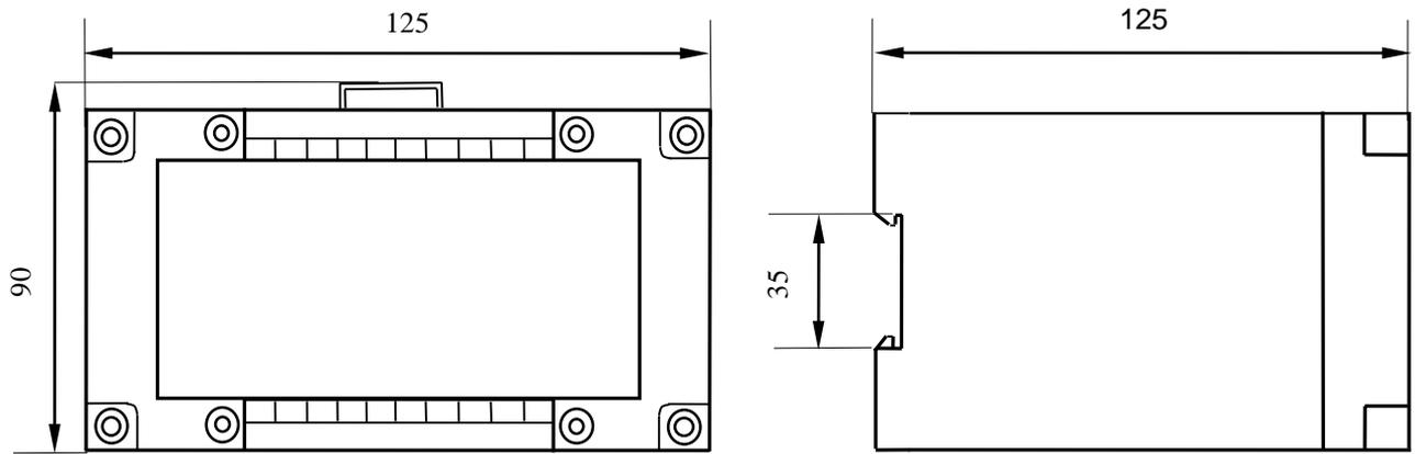
Рисунок А.7 – Габаритные размеры ЭП8554 с входными сигналами до 5 А, ЭП8555, ЭП8530
