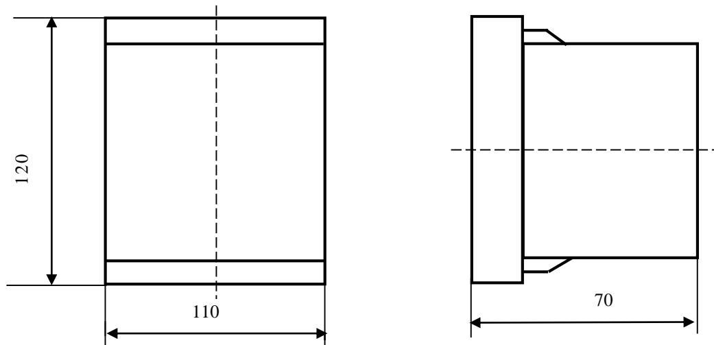
Рисунок А.4 – Габаритные размеры ЭП8554 с входными сигналами до 5 А, ЭП8555, ЭП8528, ЭП8542, ЭП8543
