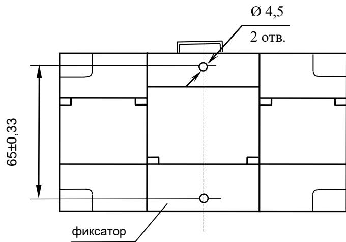
Рисунок А.8 – Установочные размеры ЭП8554 с входными сигналами до 5 А,
