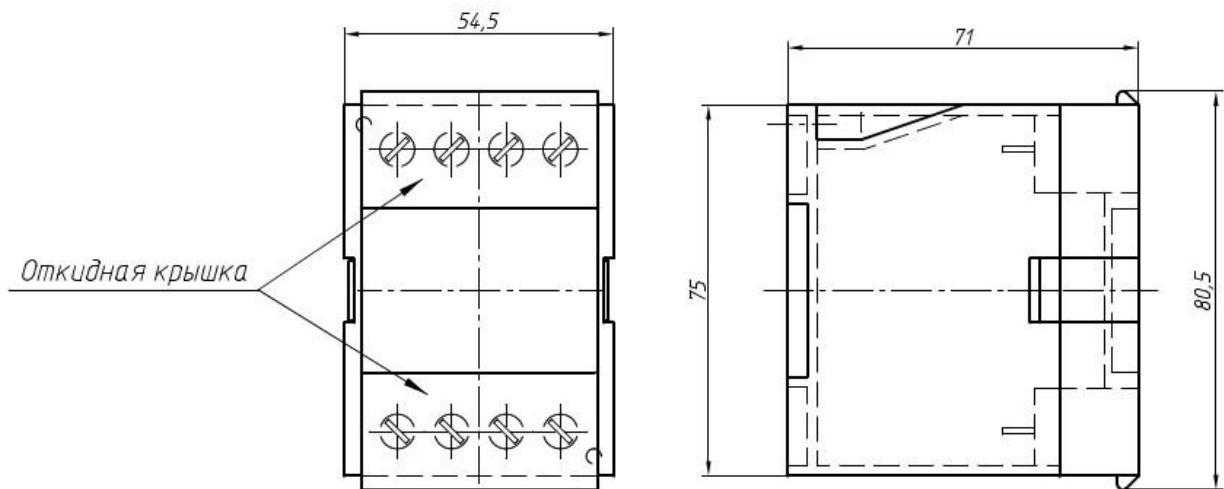
Рисунок А.9 – Габаритные размеры ЭП8554 с входными сигналами до 5 А, ЭП8555, ЭП8528, ЭП8542, ЭП8543
