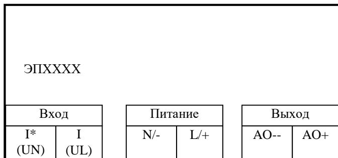
Примечание - Обозначения в скобках указаны для подключения ЭП8555 и ЭП8528.
