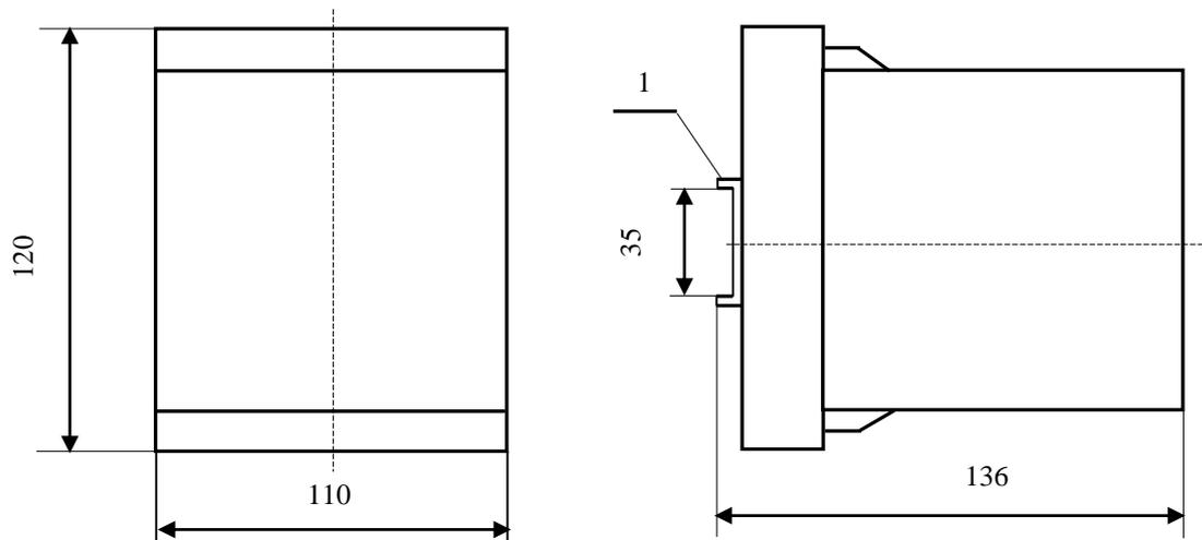
1 – два кронштейна для крепления ЭП на DIN-рейку 35 mm
