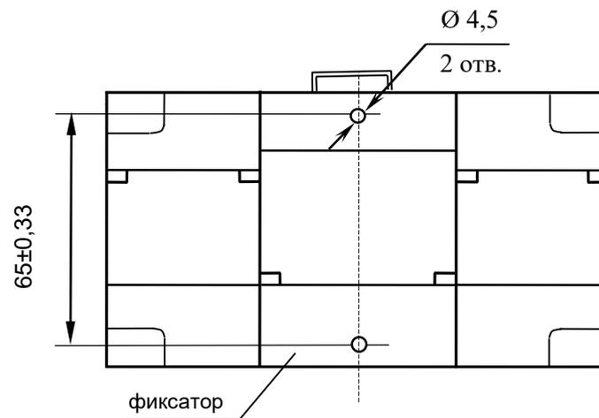
Рисунок А.8 – Установочные размеры ЭП8554 с входными сигналами до 5 А, ЭП8555, ЭП8530
