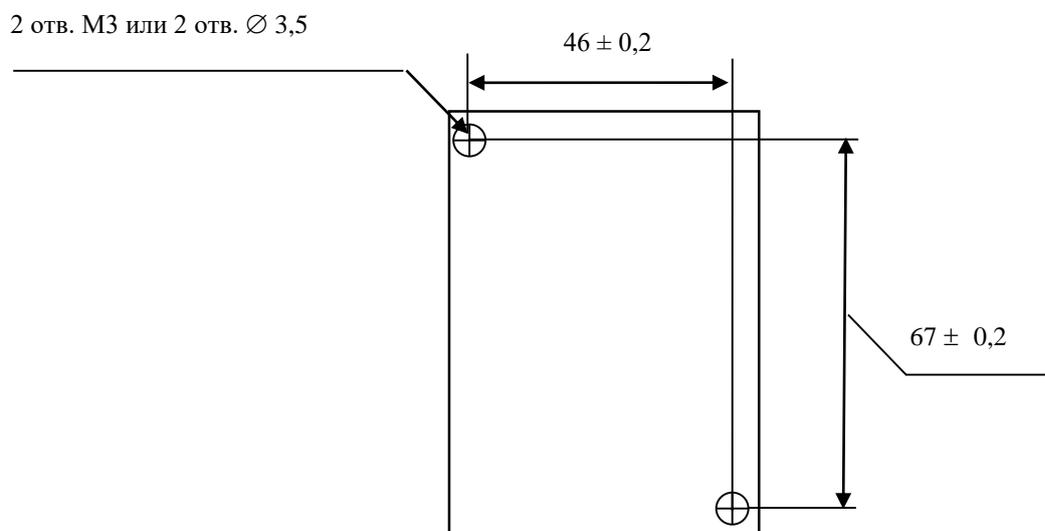
Рисунок А.10 – Установочные размеры ЭП8554 с входными сигналами до 5 А, ЭП8555, ЭП8528, ЭП8542, ЭП8543
