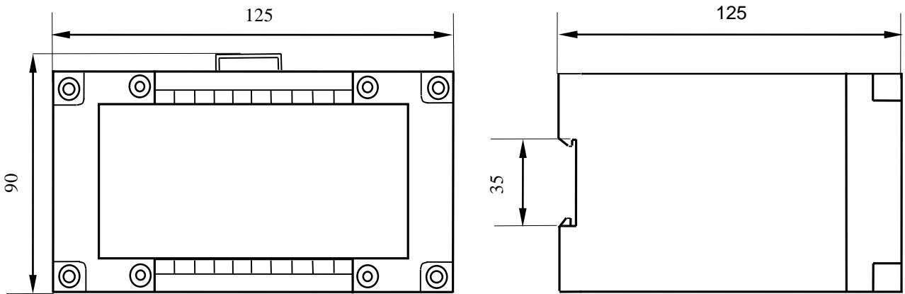
Рисунок А.7 – Габаритные размеры ЭП8554 с входными сигналами до 5 А,
