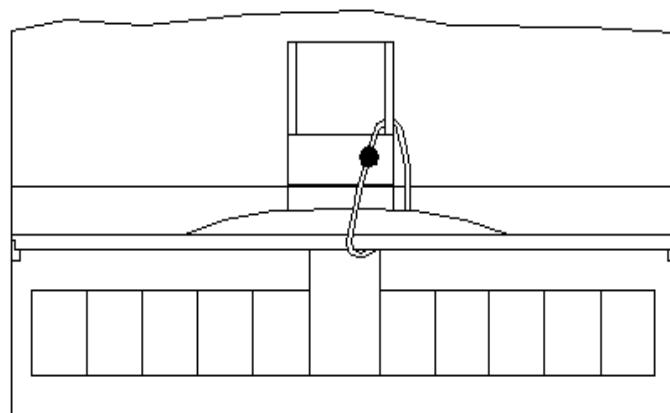
4 Закрепить леску узлом с натяжением, исключающим снятие крышки
