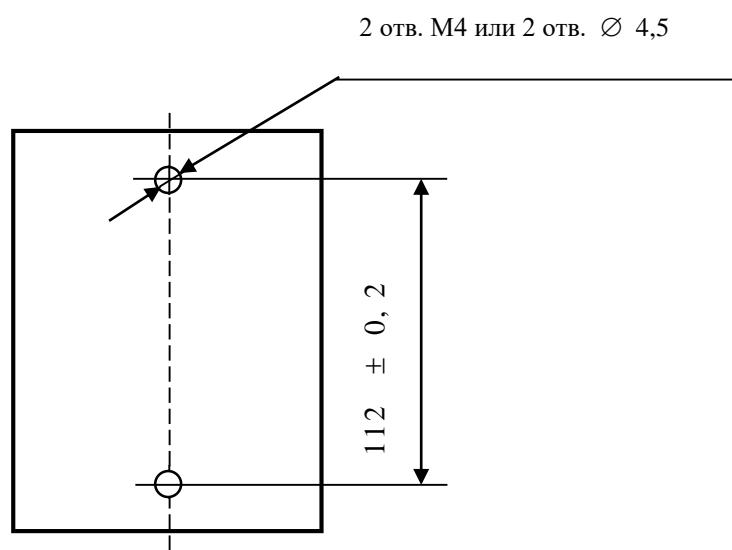
Рисунок А.2 – Установочные размеры ЭП8554 с входными сигналами до 5 А, ЭП8555, ЭП8556, ЭП8557, ЭП8530, ЭП8528
