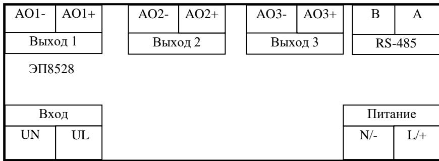
Примечание - На данном рисунке представлена схема электрическая подключения ЭП8528 с тремя выходами Количество выходов изготавливается по заказу и с дополнительным источником питания.
