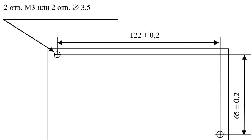
Рисунок А.12 – Установочные размеры ЭП8554 с входными сигналами выше 5А
