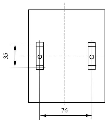
Рисунок А.6 – Габаритные и установочные размеры ЭП85554 с входными
