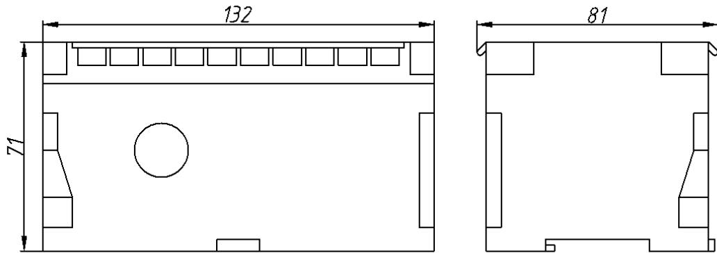
Рисунок А.11 – Габаритные размеры ЭП8554 с входными сигналами выше 5 А
