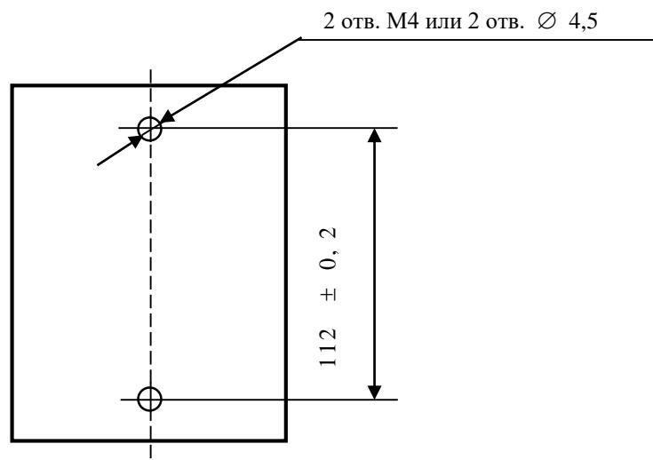
Рисунок А.5 – Установочные размеры ЭП8554 с входными сигналами до 5 А, ЭП8555, ЭП8528, ЭП8542, ЭП8543
