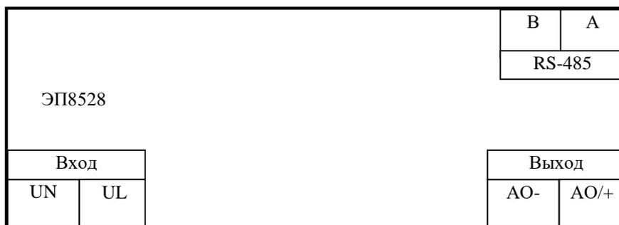
Примечание - На данном рисунке представлена схема электрическая подключения ЭП8528 с питанием от измерительной цепи.
