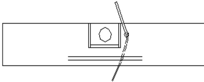
2 Вставить и защелкнуть крышку клеммной колодки
