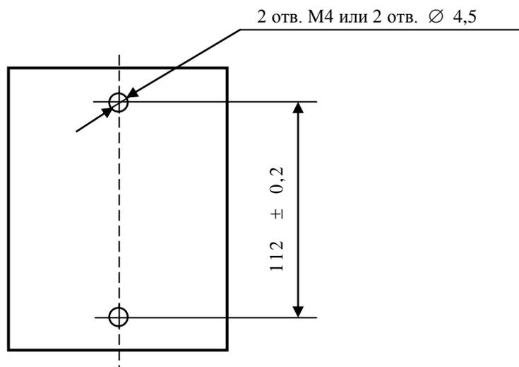
**Рисунок Г.2 – Установочные размеры блока питания**
