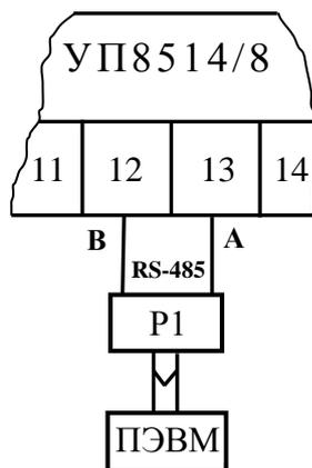
P1 – преобразователь интерфейса RS-485 в RS-232 или USB;
