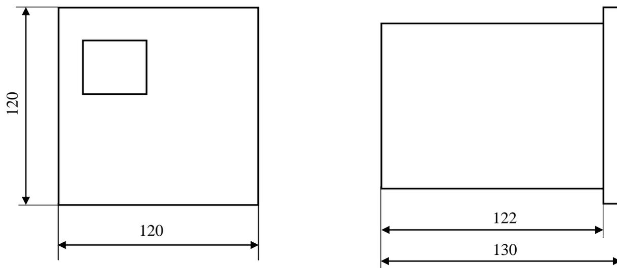
**Рисунок В.1 – Габаритные размеры блока индикации**
