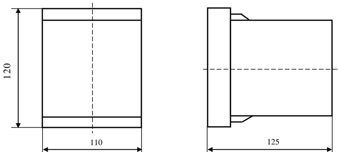
**Рисунок Г.1 – Габаритные размеры блока питания**
