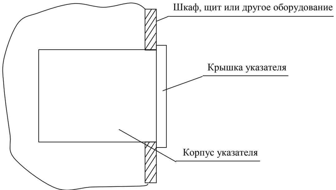
**Рисунок В.3 – Установка блока индикации в шкафы, щиты или другое оборудование**
