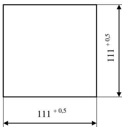
**Рисунок В.2 – Размеры окна в щите для установки блока индикации**
