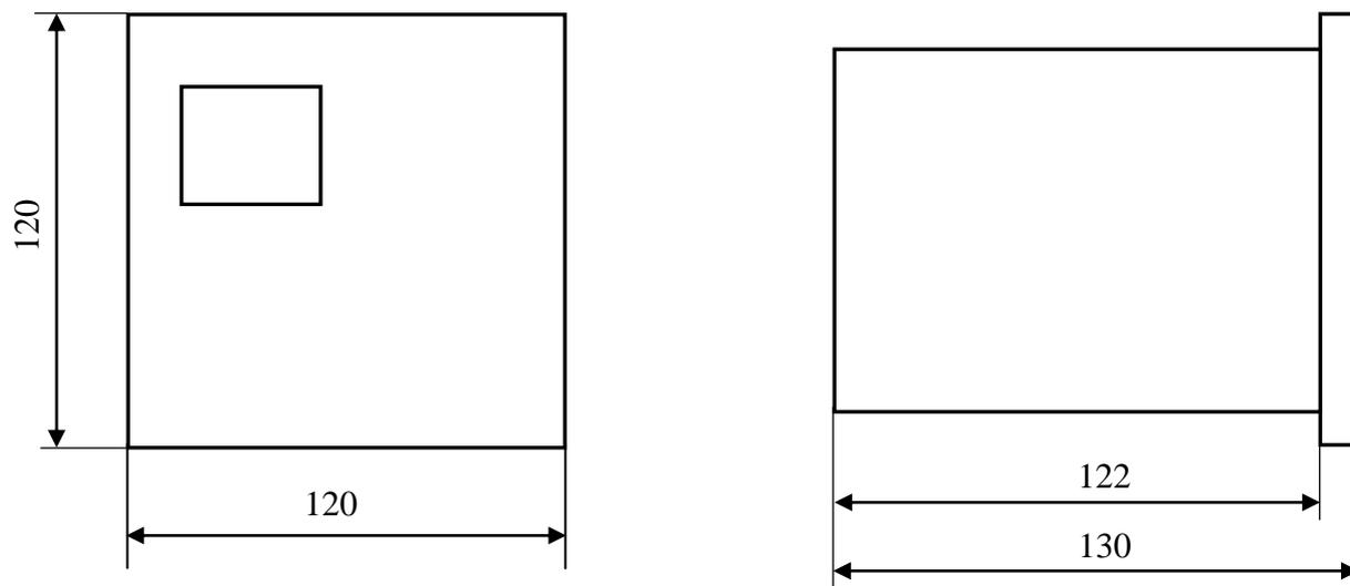
**Рисунок А.1 – Габаритные размеры блока индикации**
