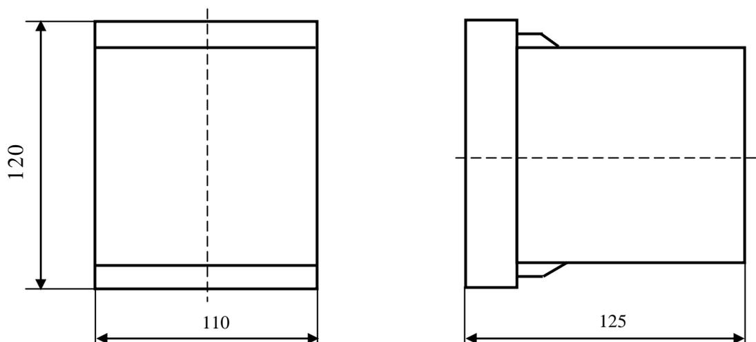
**Рисунок Б.1 – Габаритные размеры блока питания**
