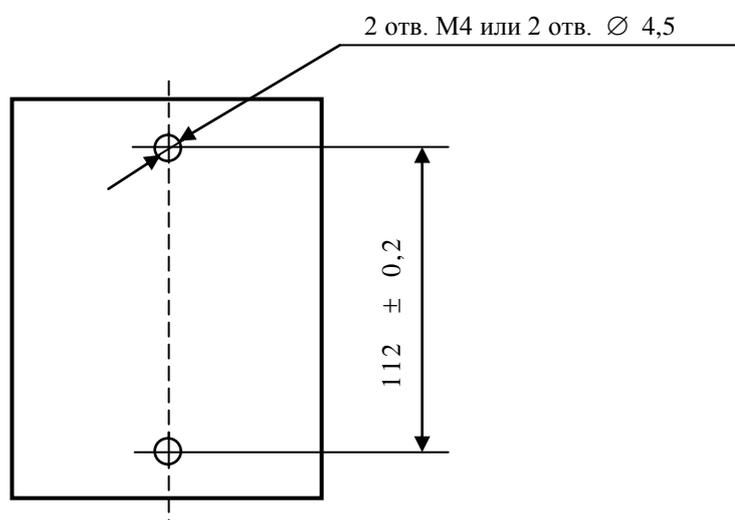
**Рисунок Б.2 – Установочные размеры блока питания**
