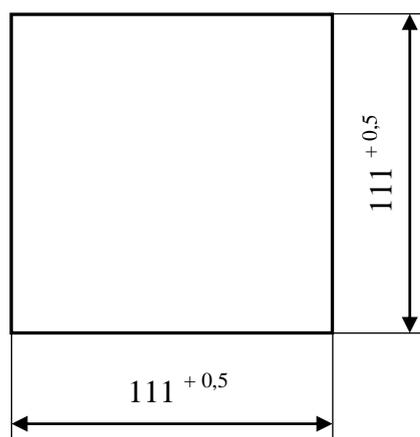
**Рисунок А.2 – Размеры окна в щите для установки блока индикации**
